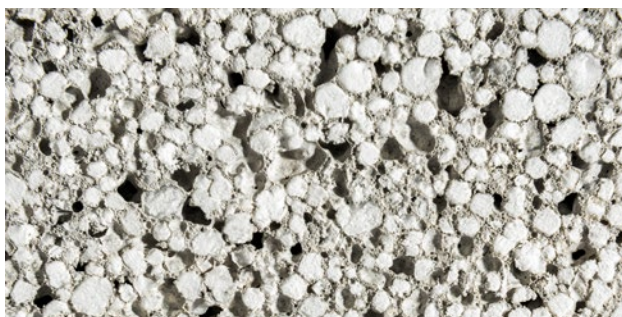
Deutlich sichtbar: gebundene EPS-Partikel in verschiedenen Sieblinien und ausreichend Luftporen.
