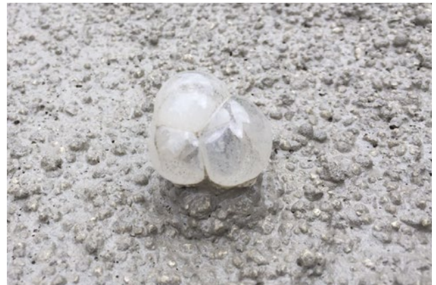
Luftporenbildung als Ergebnis des einzigartigen 4-Komponenten Bindemittels sorgt für die guten Dämmeigenschaften im Gesamtaufbau.
