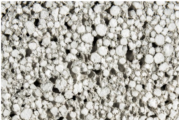
Deutlich sichtbar: gebundene EPS-Partikel in verschiedenen Sieblinien und ausreichend Luftporen.
